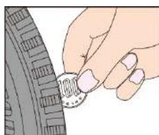
スタッドレスタイヤの交換時期が気になる方に、プラットホーム以外で残り溝をチェックする方法をご紹介します。100円玉を用意して、「100」の文字がタイヤに直角になるように溝に差し込みます。この時に「1」が見えたら残り溝は約5mmですので、そろそろタイヤ交換の時期と考えて下さい。
